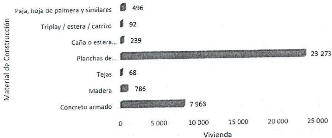
Ilustración 8. Distribución de las viviendas según material de los techos
